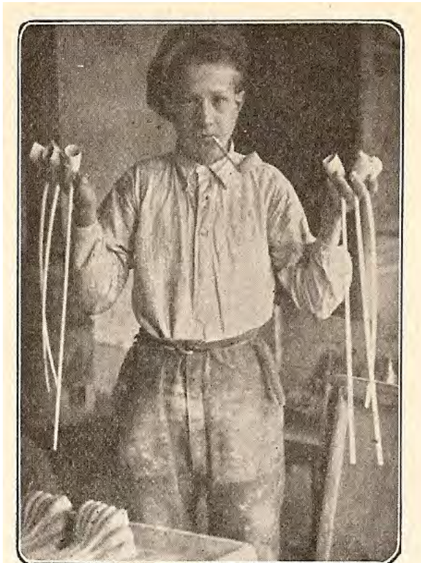
Gereed voor het gebruik. De pijpen, juist uit den oven gehaald en „gesnold”, zijn nu klaar voor de verzending.
