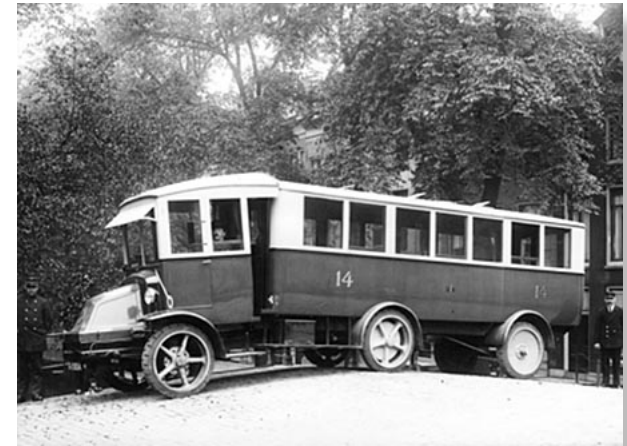
De eerste gelede bus in Amsterdam als trekker met oplegger. Geen succesnummer en later dan ook verbouwd tot star chassis, maar wel met drie assen (Foto: GVB)
