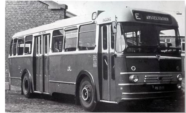
Bus 2 uit de nieuwe serie blauwe bussen van AEC met een opbouw van Verheul en een lijnfilmkast (Foto: A.M.C. Staal)
