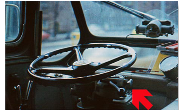
De pijl geeft het pookje van de AEC pre-selective aan (Foto: A.M.C.Staal)
