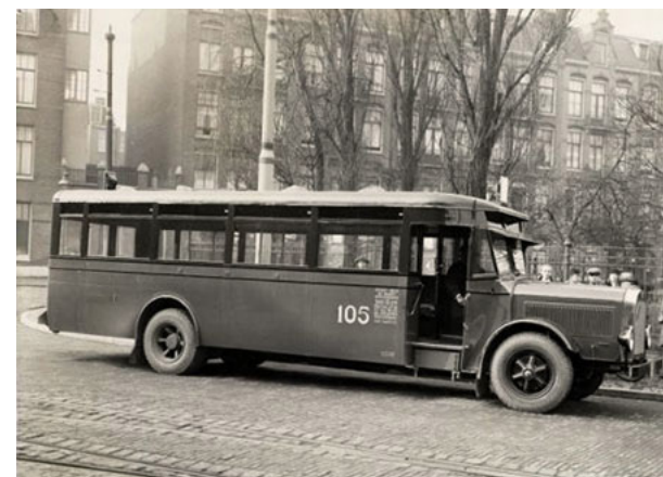
Onder een serie op Magirus chassis, eveneens een Werkspoor opbouw maar met Kromhout oliemotor, later vervangen door een Gardner dieselmotor (Foto: SAA)
