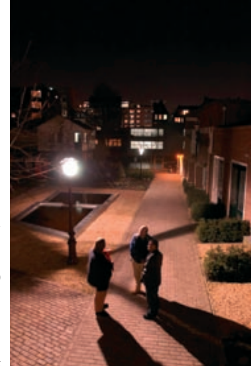
Proefopstelling maart 2003, op de voorgrond zijn goed de slagschaduwen van de stijlen zichtbaar evenals het harde, witte licht.
